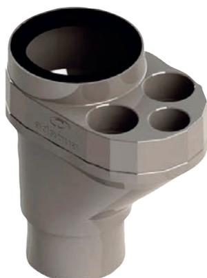
La culotte Multiconnecteur fait office de chambre de décompression et minimise les risques de désamorçage des siphons et de remontées d'odeurs. Elle augmente la capacité de raccordement des appareils sanitaires à la descente, un écoulement maximal de l'eau avec un branchement en flèche (45°). Par son design spécifique, elle facilite la vitesse d'écoulement des eaux usées et des eaux vannes en évitant la rétention et la sédimentation.
