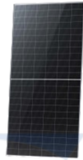
Module bifacial à 72 demi-cellules de type N 575-600 W avec double verre
